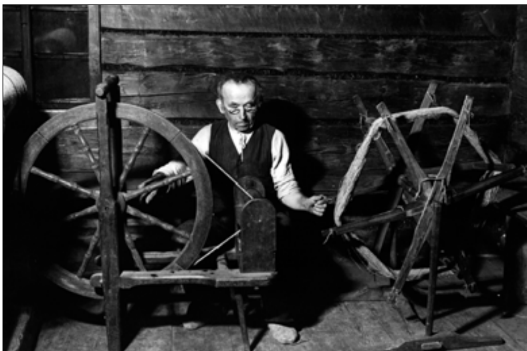
Milíkovský tkadlec Josef Sikora převíjí nitě z přáden na „kivách“ na cívky pomocí kolovratu, r. 1953, foto Karol Kaleta, Muzeum Těšínska
