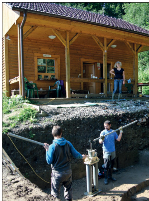
Odebírání geologických vzorků pod budoucím stavenišťem nového vstupního objektu v Archeoparku Chotěbuzi-Podoboře, foto Eva Teuerová
