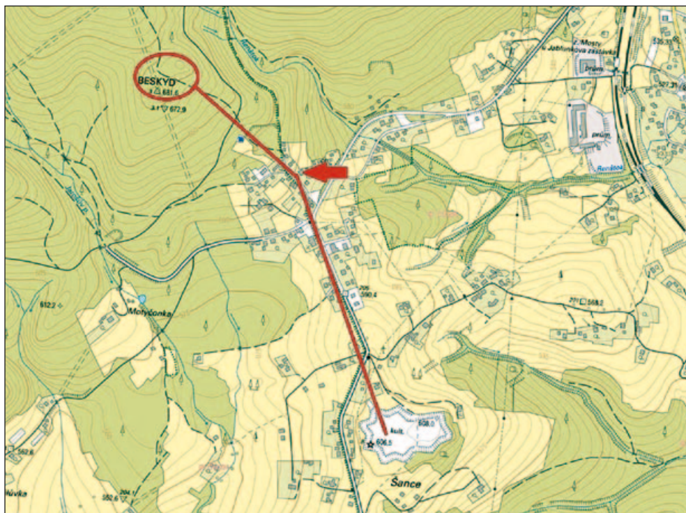
Výřez z topografické mapy okolí Velké šance se zaznačením hypotetické rekonstrukce vedení vodovodního potrubí spojující vrch Beskydu a Velkou šanci, šipkou je označeno místo nálezu, mapový podklad: http://cuzk.cz , kresba Martin Krůl
