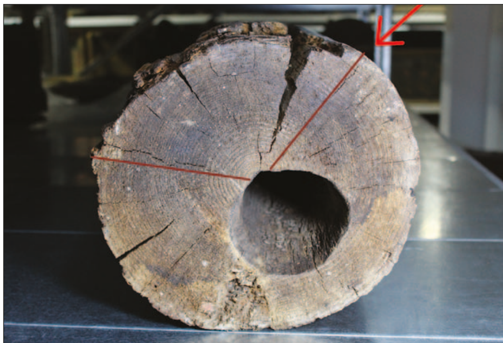
Čelní pohled na dochovaný kus potrubí s označením směru odběrů dendrochronologických vzorků, Muzeum Těšínska, foto Petr Bělíček
